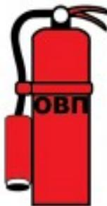
Предназначен для тушения пожаров твердых и жидким веществ. Перезаряжается один раз в год.
